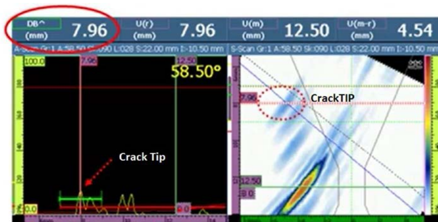
Figura 5 - Sinal de ponta da trinca
